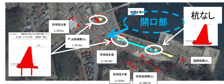
図 山田漁港防波堤の飛散状況及び洗掘範囲 (3)
