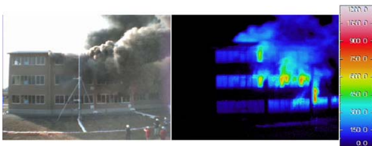
図 11 点火後 10 分の北東側の熱映像と可視画像 (温度スケールの範囲は 0~1200°C)
