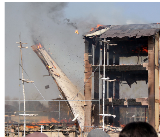
96分：防火壁倒壊
