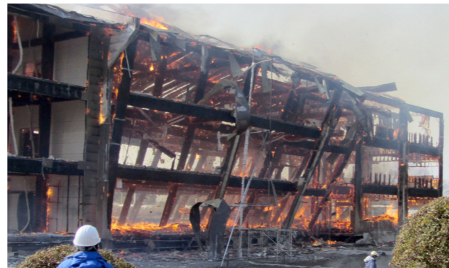
75分：軸組中央部分倒壊
