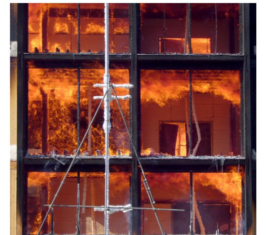
42分：防火扉状況
