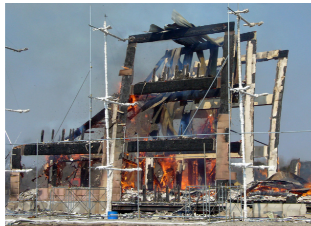
94分：柱組部分倒壊
