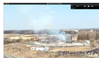
122分：軸組東部分倒壊
