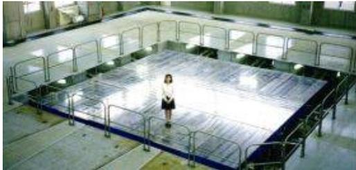
振動実験施設(三次元大型振動台)
