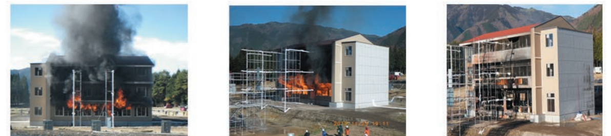
木造3階建て建物の火災実験の様子
