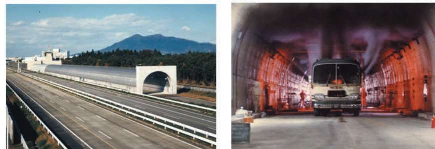
実大トンネル実験施設の全景 火災実験の様子
