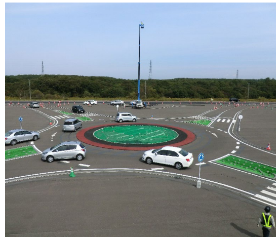
図-4 ラウンドアバウトの適用交通量に関する実験の様子（於：寒地土木研究所）
