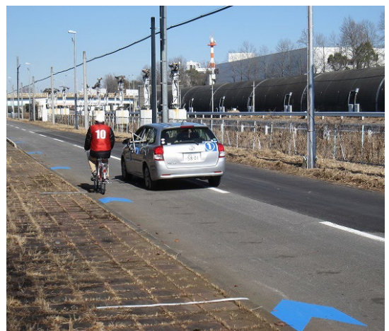
図-3 矢羽根表示に関する実験の様子 (於：国総研 構内道路)
