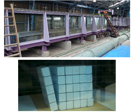
図5 風洞水槽におけるコンテナ倒壊実験 風景固縛方法の違いによる耐風性
