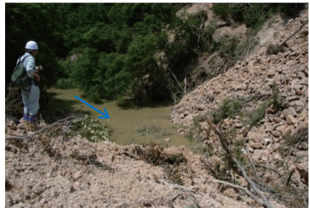
図-2 土砂災害研究部による河道閉塞(天然ダム)の現地調査(2008年岩手・宮城内陸地震) 形成した河道閉塞(天然ダム)において崩壊土砂の堆積状況と上流側の湛水状況を現地調査。
