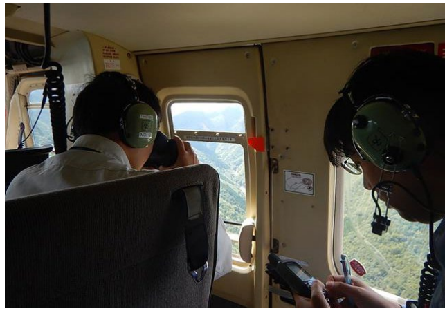
図-5 「高度な土砂災害対策に従事する地方整備局職員の育成支援プログラム」の実施状況 ヘリの機内からレーザー距離計で天然ダムの高さを計測する様子。
