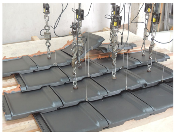
写真-7 粘土瓦の載荷実験
