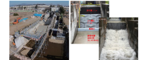
大規模実験施設による堤防の破堤実験
