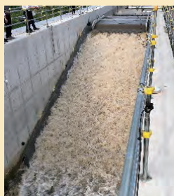
大規模堤防模型実験
