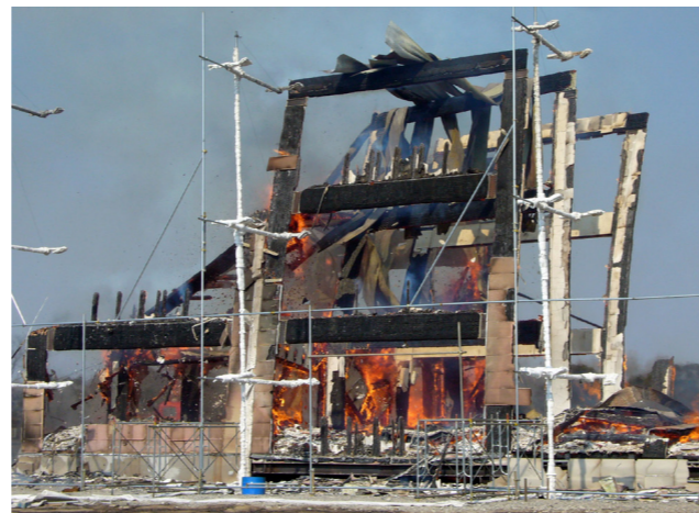
75分：軸組中央部分倒壊
