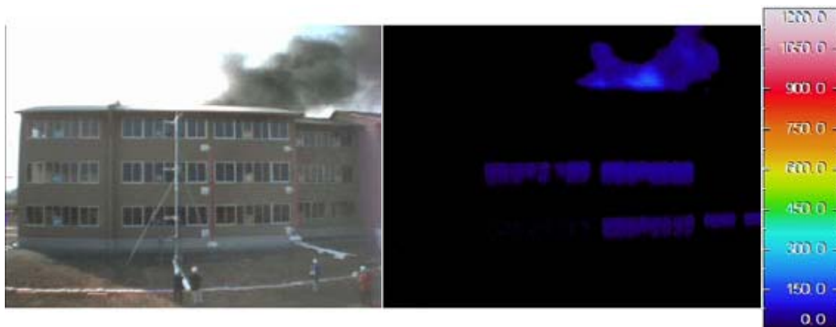
図 10 点火後 7 分の北東側の熱映像と可視画像 (温度スケールの範囲は 0~1200°C)
