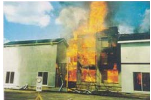
木造三階建共同住宅火災実験写真
