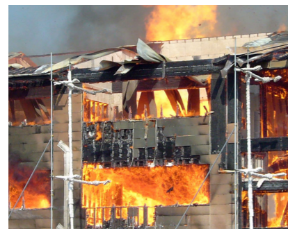
59分：枠組部分と65分：軸組部分の屋根状況
