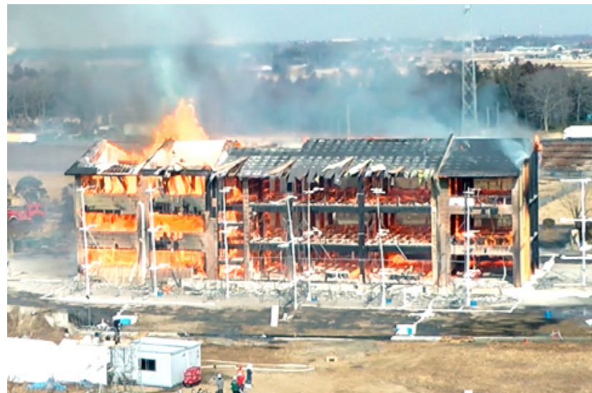
75分：軸組中央部分倒壊
