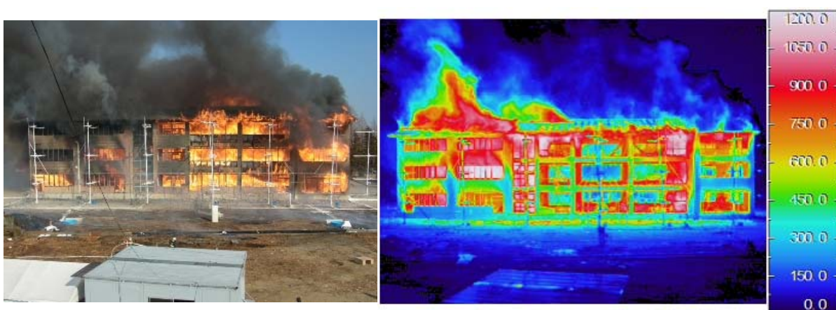
図 15 点火後 45 分の南側の熱映像と可視画像（温度スケールの範囲は 0～1200℃）
