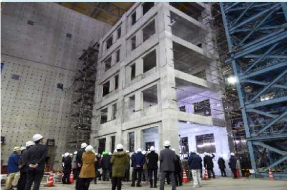
実大5層鉄筋コンクリート造建築物の載荷試験
