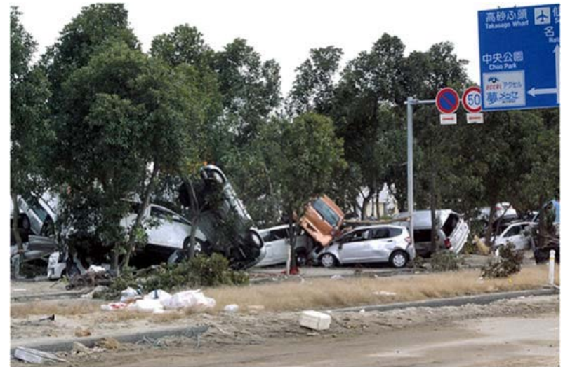
樹林帯が津波漂流物を捕捉した例 (宮城県仙台市)
