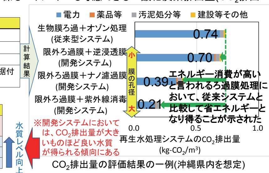
エネルギー消費抑制には、適切な送水地域設定、必要な水質に応じた処理システム選定が重要
