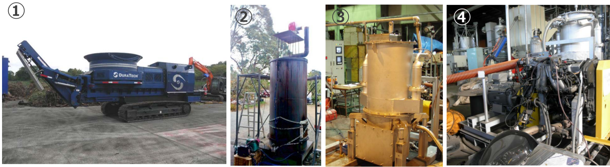
写真 実験に用いた設備(①破砕機 ②炭化炉 ③ガス化炉 ④ガスエンジン)
