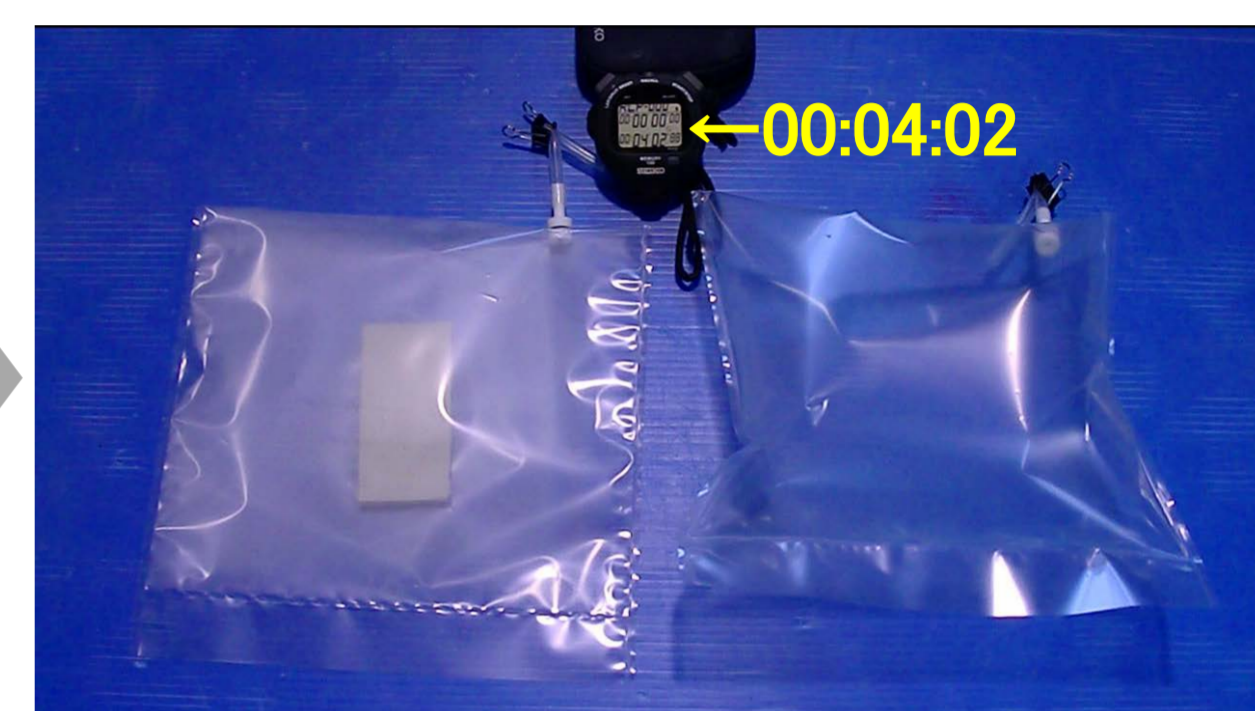
Ca(OH) 2 + CO 2 → CaCO 3 + H 2 Oにより、左のパックだけがしぼみ、水滴が付着
