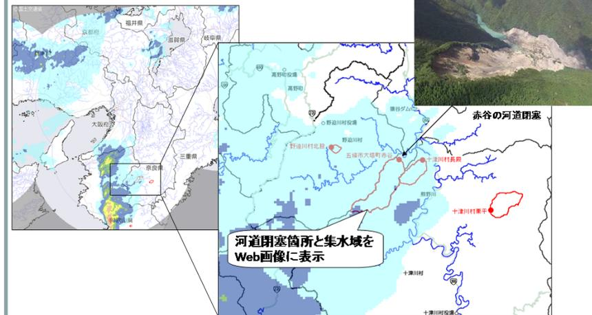
H23年台風12号に伴い発生した河道閉塞の決壊監視のためにXRAIN雨量画像に河道閉塞箇所と集水域を表示。また、集水域内の累積雨量に応じてアラートメールを関係者へ配信
