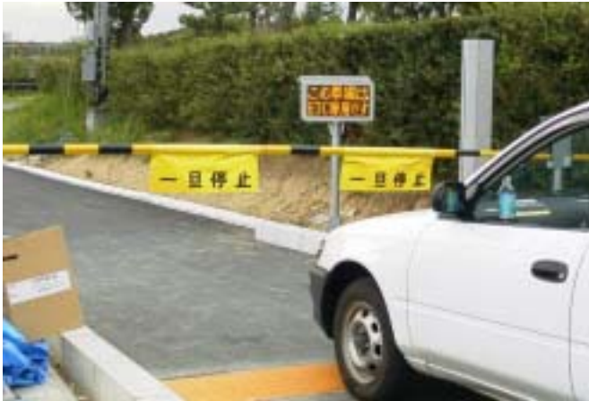
図7 非ETC車誤進入試験状況(上郷SA)
