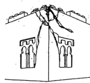
上部の壁交差部の破壊 Damage to upper wall intersections
