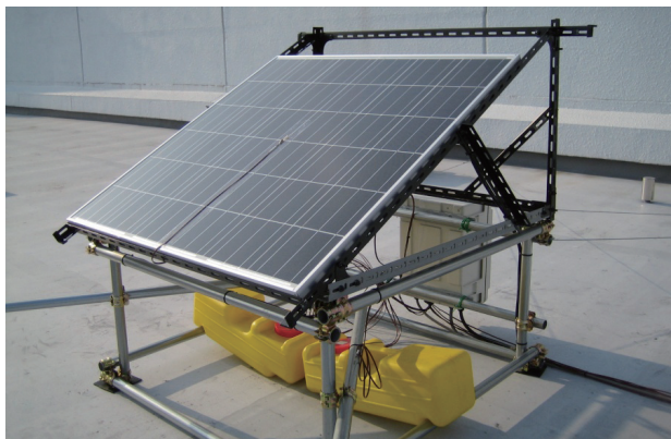
図2 屋上緑化・ソーラーパネルの設置効果の比較実験 (国総研立原庁舎屋上で実施) Solar panel experiment Rooftop greening experiment
