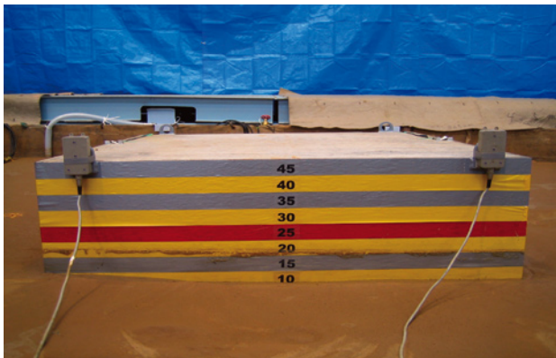
写真-3 無対策地盤100gal加振後
